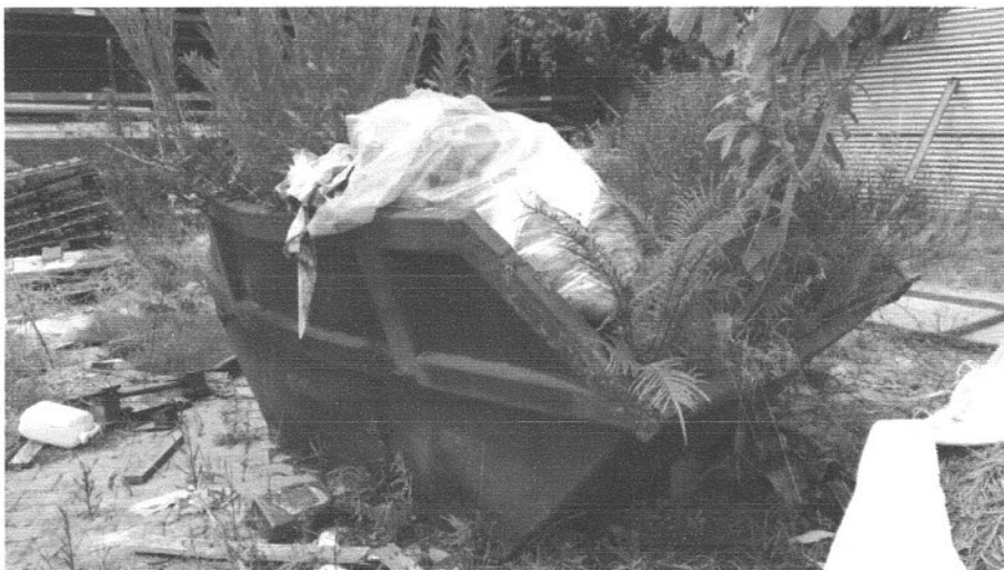
CAÇAMBA DE PRÓPRIA PARA TRANSPORTE DE ENTULHO AMASSADA, SUCATA.
